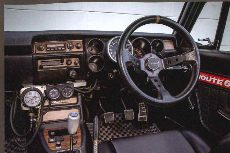
●「走り」の実用本位にまとめられた室内。センターコンソールのゲージは右から油圧、油温、燃圧。ステアリングはブランドではなく、コーンの深さで選んだ。「もっと手前にもって来たくて。ウインカーレバーが遠くなりました」。
