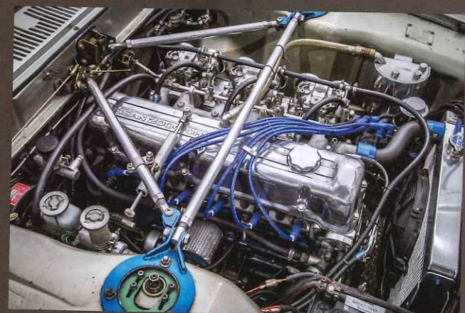
●エンジンはL20型はそのままに、φ44のソレックスやアバンス名東のタコ足などで当時の走り屋の雰囲気を今に伝える。カムは和光の75S。ミッションは今なきルート6製のクロスレスタイプ。クラッチはOS技研のツインプレートだ。ストラットタワーはGT用。本来、GT-RとGT-Xはバルクヘッドにリンクがあるの
