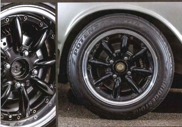
15インチのRS8、フロントブレーキキャリパーはR32スカイラインMタイプ用。キッドラムはアルフィンタイプとし、その表側を光沢研磨している。
