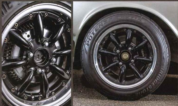
●ホイールは15インチのRS8、フロントブレーキキャリパーはR32スカイラインMタイプ用。リヤのブレーキドラムはアルフィンタイプとし、その表側を光沢研磨している。
